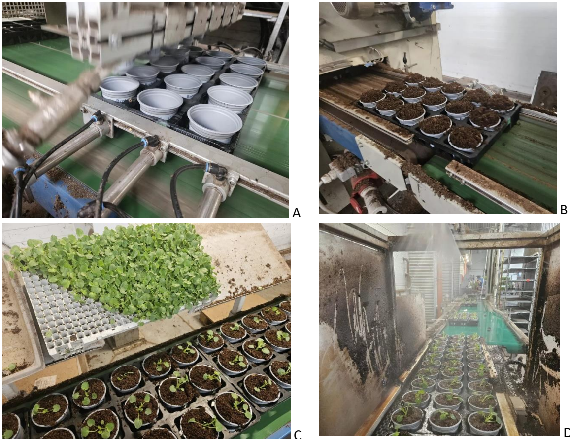
Ryc. 4. Proces zautomatyzowanego sadzenia roślin za pomocą doniczki i sadzarki na przykładzie bratka ogrodowego: A – napełnianie doniczek podłożem, B – wyrównywanie powierzchni podłoża, C – sadzenie siewek bratka pobieranych z paletki produkcyjnej Xtray® 480 Syngenta, D – automatyczne podlewanie roślin po posadzeniu poprzez zamgławianie.
